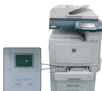
除湿ヒーターのスイッチは給紙カセット1を開いた場所にありませ
